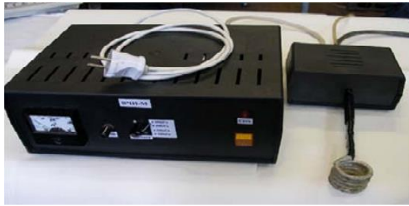
Рисунок 1.5 – Експериментальна установка для магнітно-рідинної гіпертермії. Адаптовано із роботи [3]
